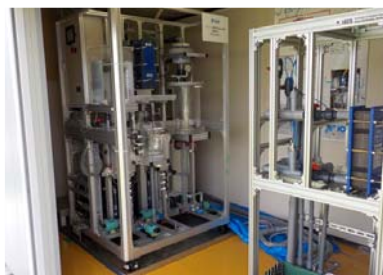
佐賀大学 温度差を利用した海水淡水化実験 (2014年10月～)
